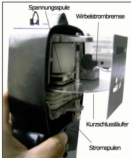
hat eine ähnliche Wirkungsweise wie ein Asynchronmotor mit Kurzschlussläufer. Im Luftspalt zwischen den Polen zweier Magnetsysteme ist eine Aluminiumscheibe drehbar gelagert. Durch das untere Magnetsystem fließt der zu messende Strom, am oberen Magnetsystem liegt die zu messende Spannung an. Es entsteht ein magnetisches Wanderfeld, das in der Aluminiumscheibe Wirbelströme hervorruft.
