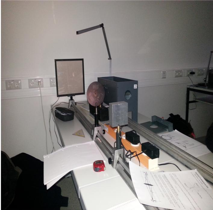
Versuche zur Abbildungsqualität bei Verwendung einer Lochblende (statt einer Linse).
